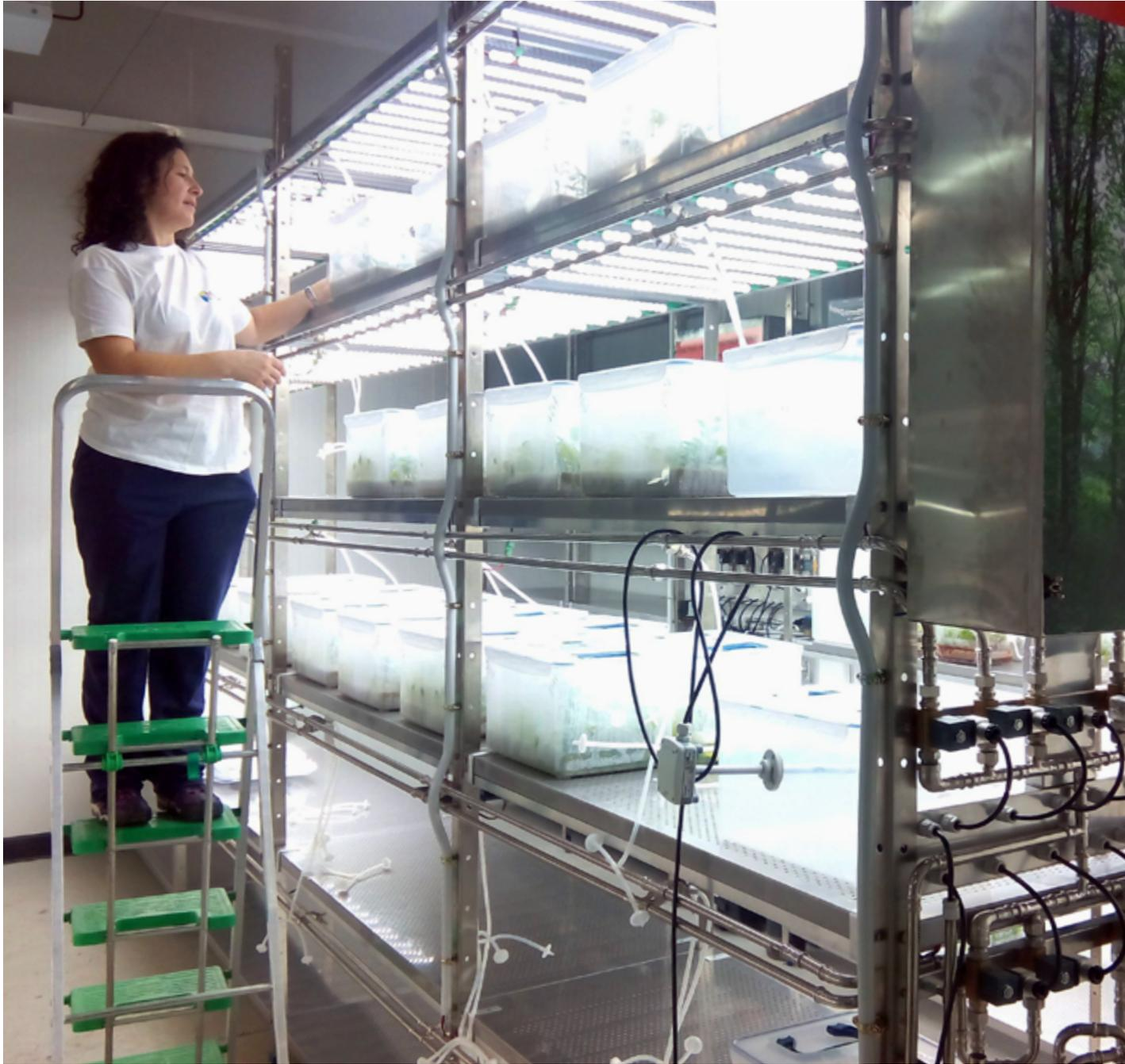
Prototipo de biorreactor fotoautotrófico desarrollado en el vivero.
