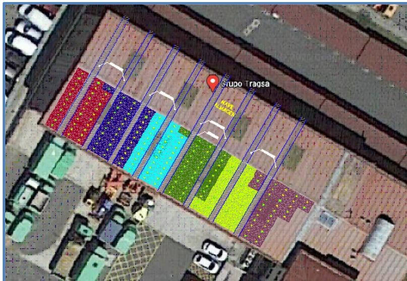
La estructura es modulable por lo que la longitud de esta la define el número total de paneles solares que se coloquen en una fila. La superficie ocupada por la planta fotovoltaica, incluyendo la separación entre paneles, será de 497 m<sup>2</sup>.
