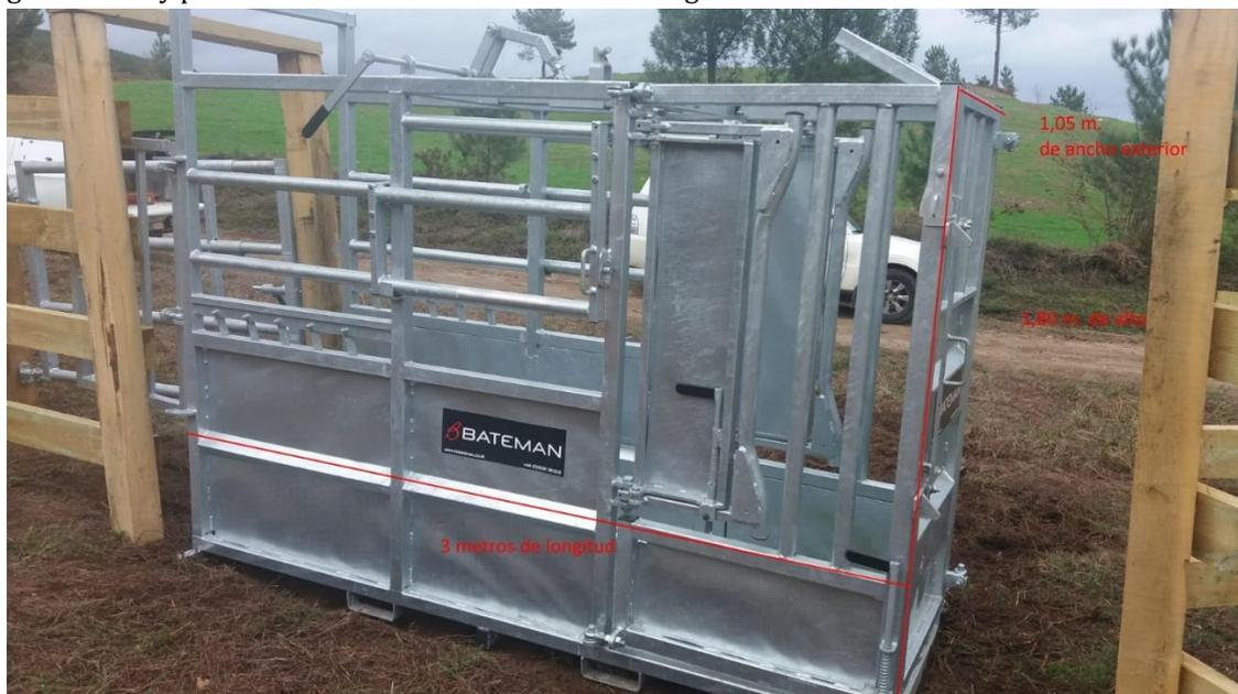
3.1.- Potro móvil con puerta de contención de final de manga para ganado bovino, modelo Daura de Bateman o equivalente: cabezal con doble puerta de tenaza, lateral regulable y con doble puerta. Altura 2,25 m, anchura equipo 1 m. y paso interior 0.80 m. Suministrado en obra según cuadro de distribución.
