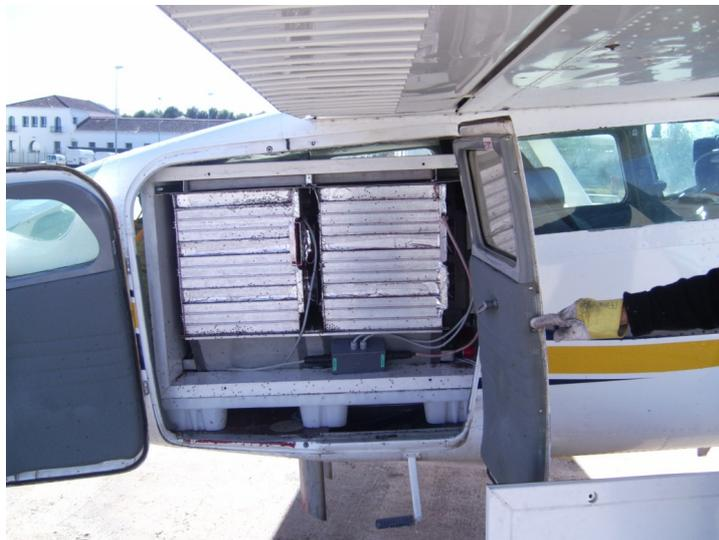
Imagen de caja que alberga la máquina de liberación de insectos montada sobre aeronave modelo CESSNA 206
