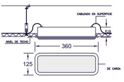
Aparato autónomo de alumbrado de emergencia, empotrado en techo o pared, dotado de un difusor de policarbonato autoextinguible, acumulador y piloto indicador de carga
