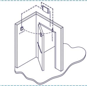
Con una salida por rele con contactos libres que ejecuta una maniobra programada con una entrada digital que confirma que se ha ejecutado. Sistema de seguridad para cierre programado de puertas cortafuegos
