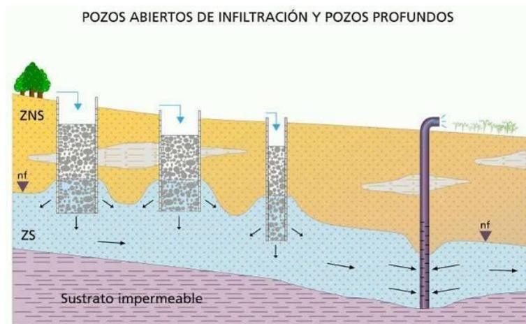
Figura 65. Esquema de un dispositivo de pozos abiertos de infiltración y pozos profundos.
