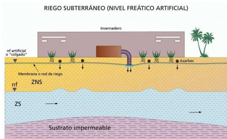
Figura 68. Esquema de un sistema de recarga artificial a través de un sistema de riego subsuperficial o subterráneo.
