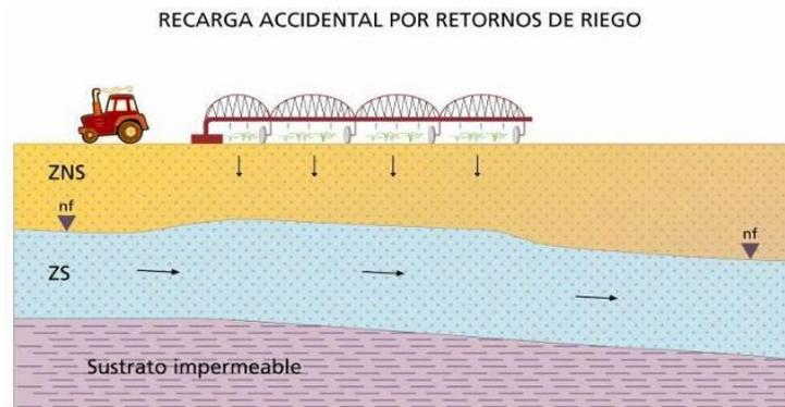
Figura 67. Esquema de un sistema de recarga artificial a través de un sistema de riego tradicional.
