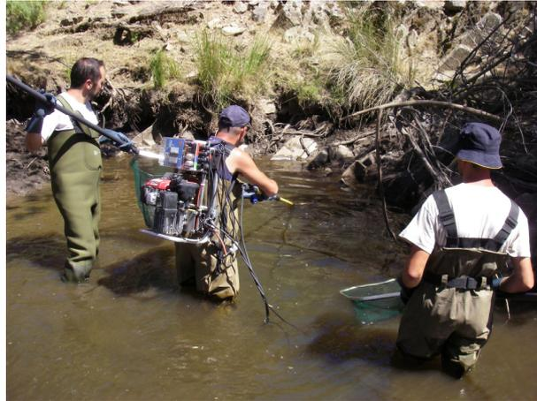
Figura 2. Aparato portátil de pesca eléctrica utilizado
