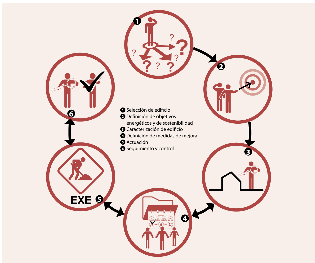
Figura 8. Proceso esquemático de la metodología de rehabilitación sostenible.
