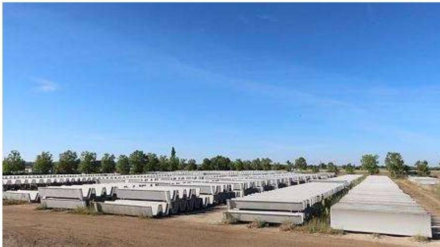
*Acopio exterior de Acequias en la Planta de Prefabricados de Hormigón de Mansilla de las Mulas (León)*
